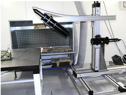
Phasen-Doppler-Anemometer, PDA. Tropfengrößen und Geschwindigkeiten hoch auflösend in 3-D messen.
